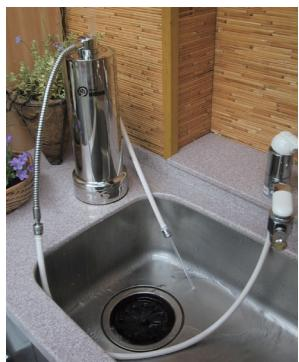
ろ過能力試験後のエリクサーを使用し、逆流洗浄を実施。逆流洗浄の初流水(合計 100L)を採水・測定しました。
